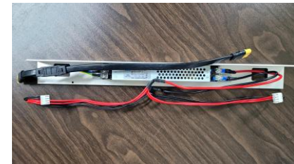
④ 전원(SMPS) 및 후면 AI 커버, 전원 코드 어셈블리
